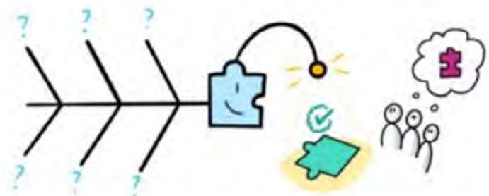
Le diagramme d'Ishikawa ou diagramme des causes et des effets permet d'orienter l'attention vers des causes que l'on n'aurait pas envisagées. En ce sens, il permet une remise en question des idées reçues.
